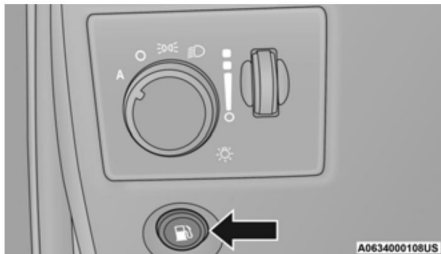
Spínač uvolnění dvířek palivové nádrže
